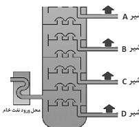
۷۴- در بخشی از یک برج تقطیر نفت خام، مطابق شکل اگر شیرهای متصل به هر برش نفتی را باز کنیم، از کدام لوله ماده خروجی سریعتر خارج می شود؟
